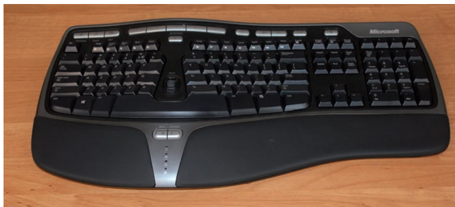
Ilustracja nr 12: Klawiatura o dzielonej konstrukcji z amortyzowaną podkładką pod nadgarstki.
